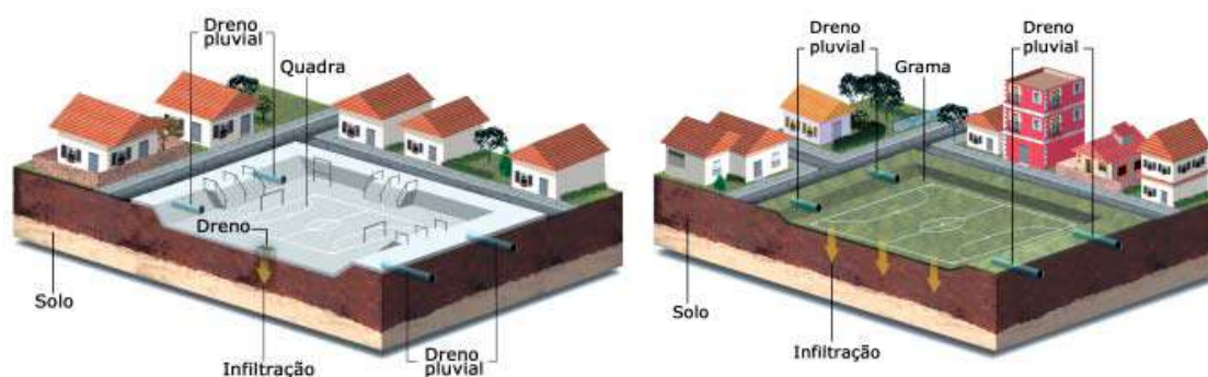
Figura 95 - Bacia de amortecimento em praça de esportes.
