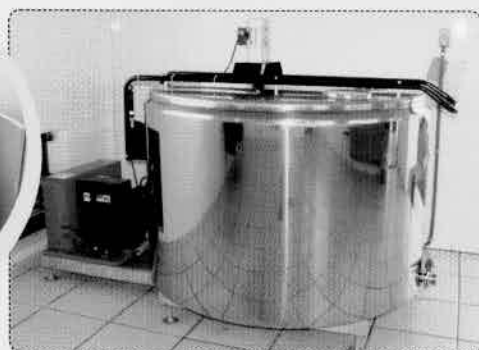
Resfriador de leite em aço inox 304 de 300 a 20.000 litros.
