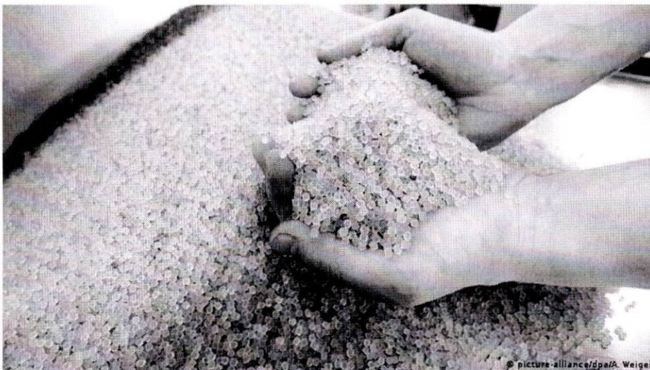
A partir destes grânulos, são fabricados todos os tipos de produtos plásticos
